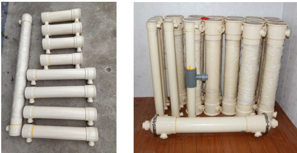
PTFE 中空纤维膜和膜蒸馏组件
